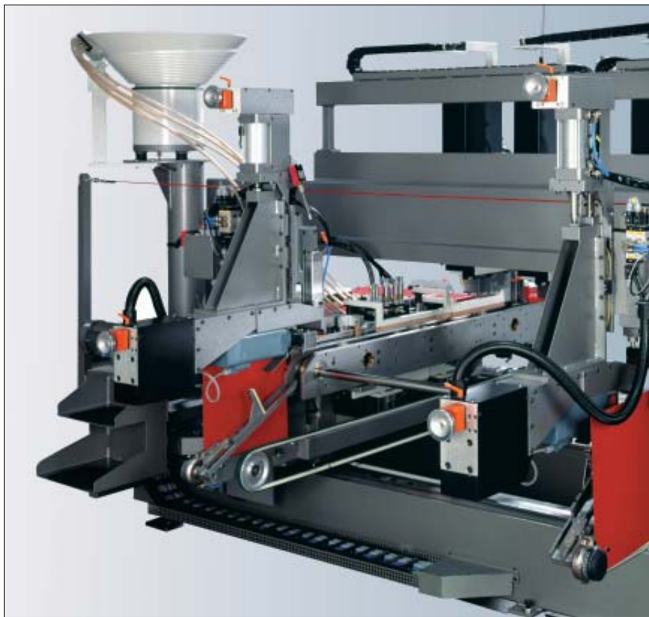
Längsbohrereinheit am Maschinen- auslauf an der rechten und linken Maschinenseite.
